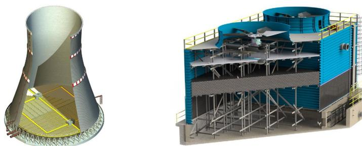
**Оросительное устройство** – основной элемент градирни, отвечающий за ее охлаждающую способность. ЮМАТЕКС предлагает линейку высокоэффективных решетчатых и пленочных оросителей.
